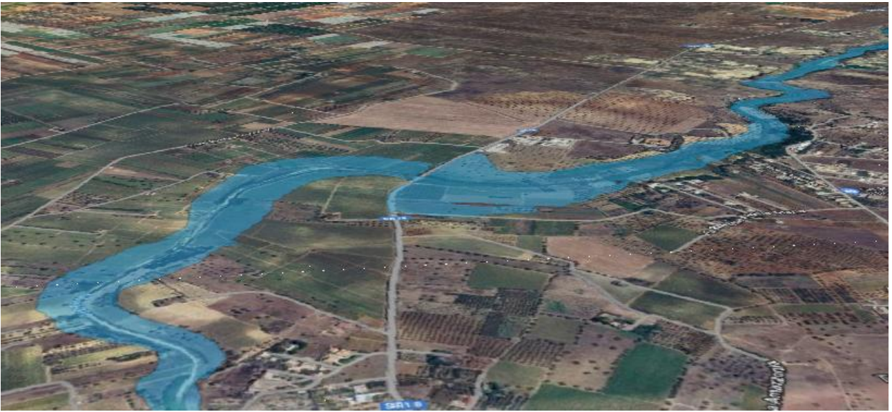
Fig. 24. Vista a volo d'uccello - Aree scucettibili di allagamento - F. Mazaro - Tr = 50 anni
