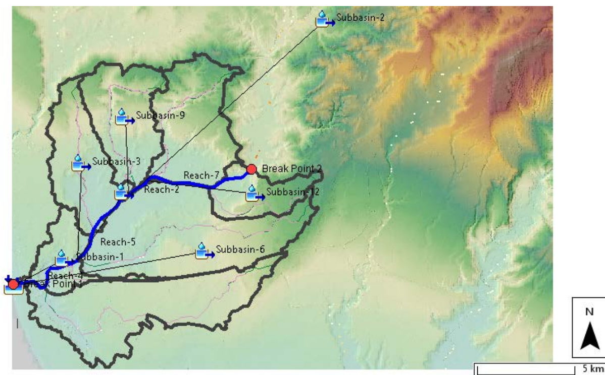
Fig. 16. Schema di calcolo bacino Fiume Arena - HEC HMS
